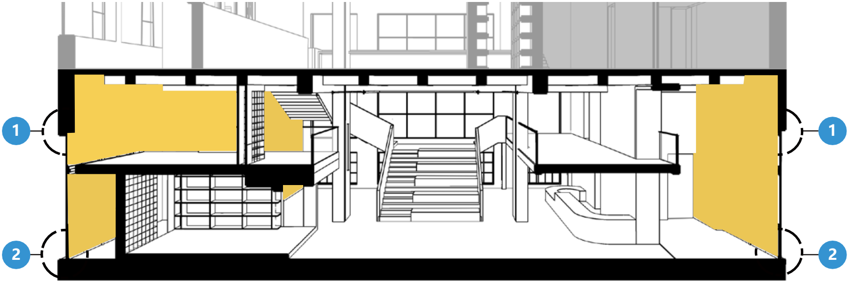
新建墙壁, 改善入口处的隔热效果
